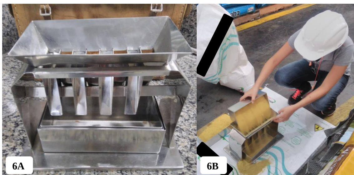
Figura 6. Quarteador tipo "Johnes" (6A); Passagem de produto através das canaletas do quarteador (6B).
