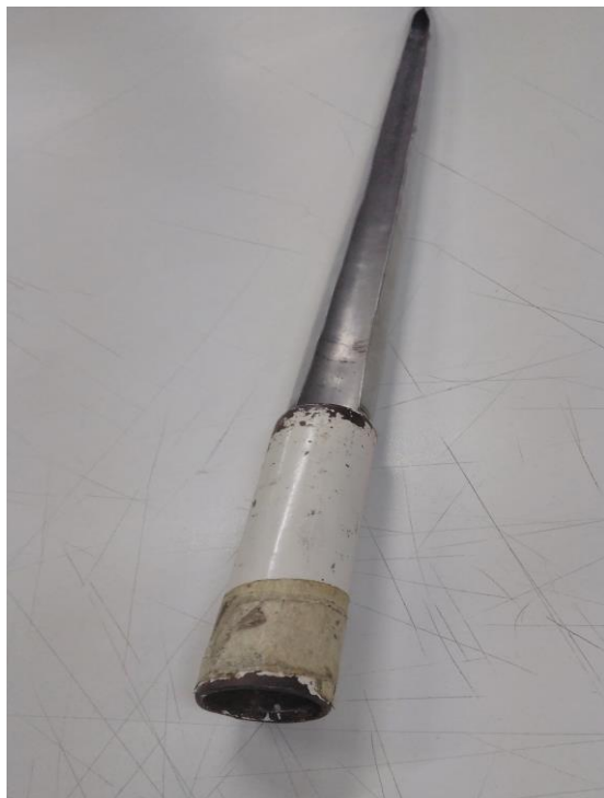
Figura 2. Calador utilizado na colheita de amostras de produtos ensacados.
